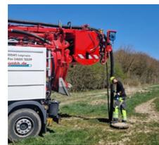
Kanalspülfahrzeug Firma Wurz Rohr- u. Kanalreinigung
